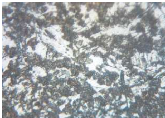
写真 1 2 高張力鋼アーク溶接部の細粒部
