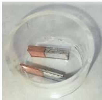
写真1 埋め込み樹脂容器に試験片をセットした状態
