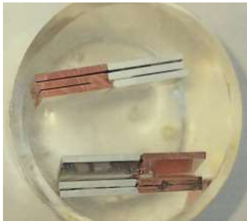
写真3 研磨、エッチングされた試験片
