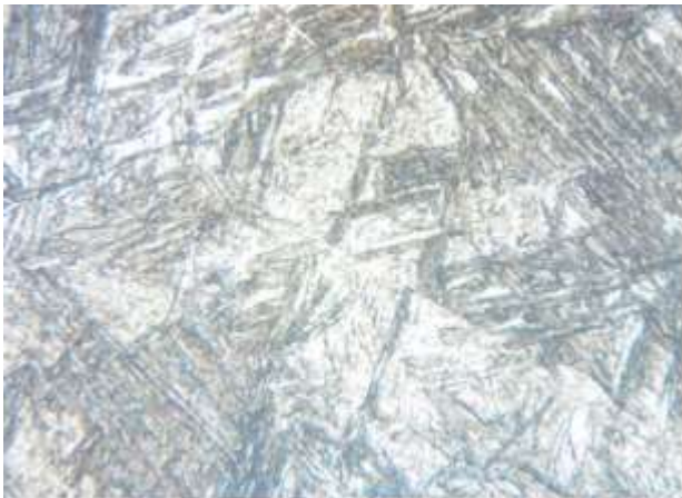
写真9 軟鋼アーク溶接部の粗粒部
