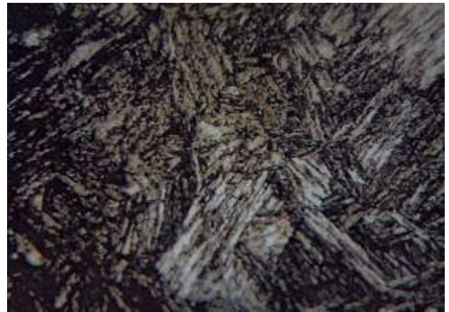
写真10 高張力鋼アーク溶接部の粗粒部
