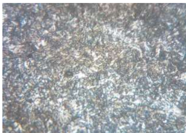
写真 1 2 高張力鋼アーク溶接部の細粒部
